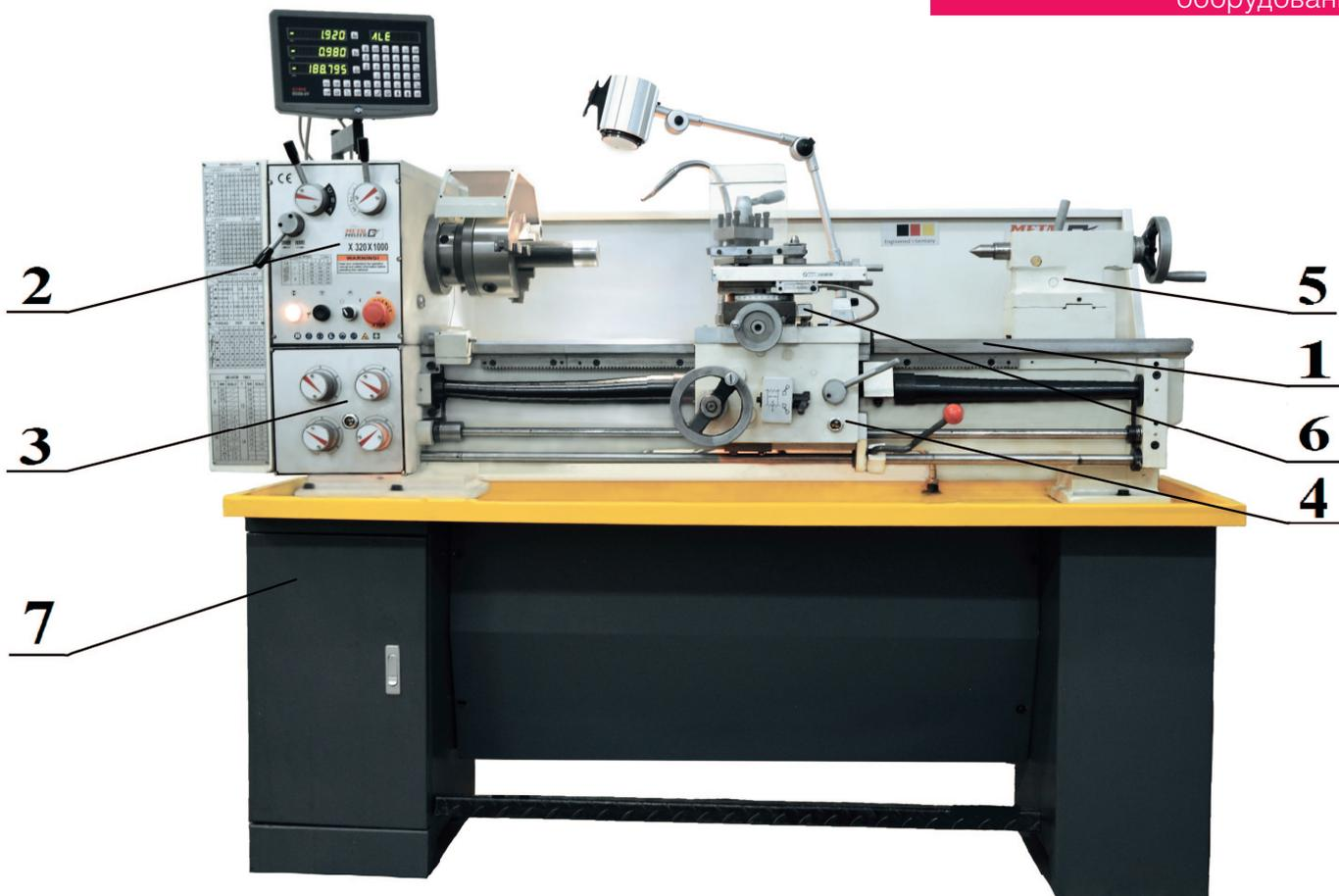
Рисунок 1. Универсальный токарно-винторезный станок X32100 серии METAL MASTER «X»
