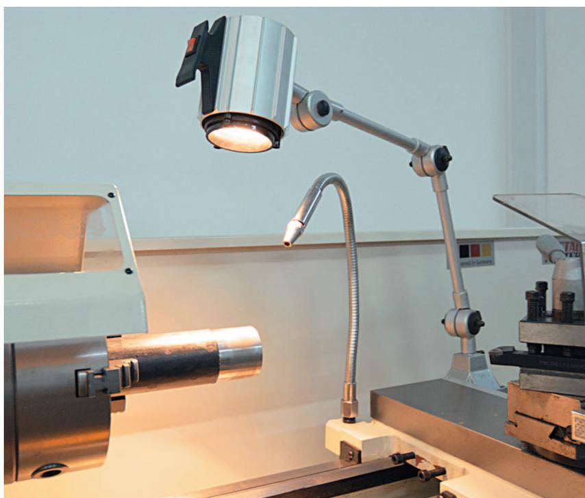
Рисунок 3. Система подачи СОЖ на станках METAL MASTER «X»
