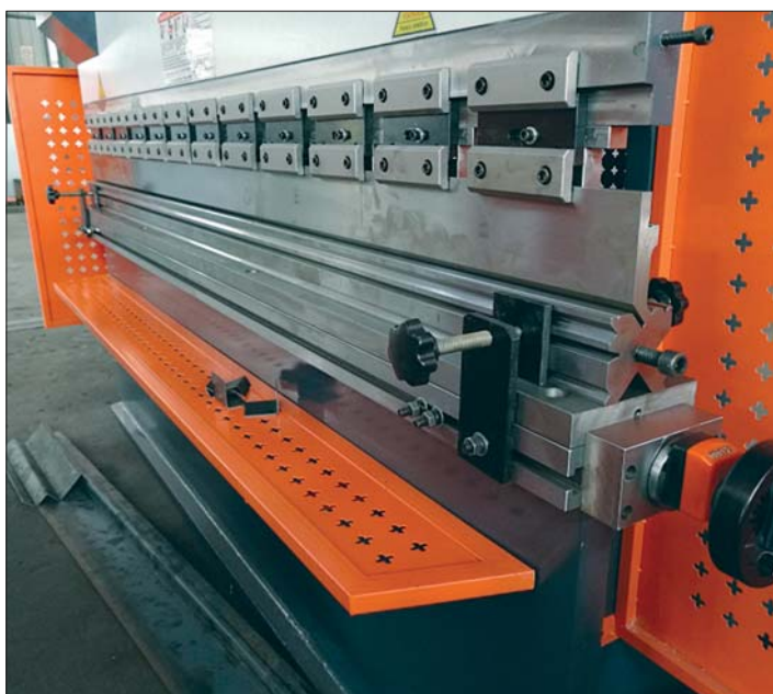
Рис. 4. Т-образный паз на рабочем столе станка
