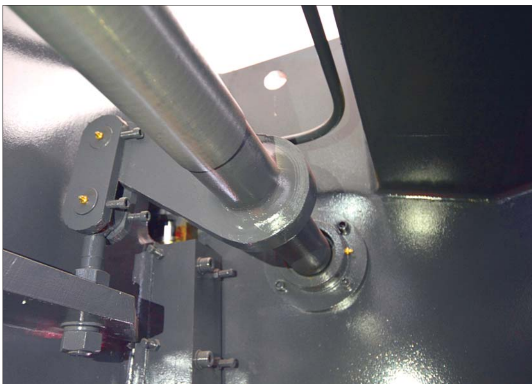
Рис. 3. Использование торсиона для синхронизации гидроцилиндров
