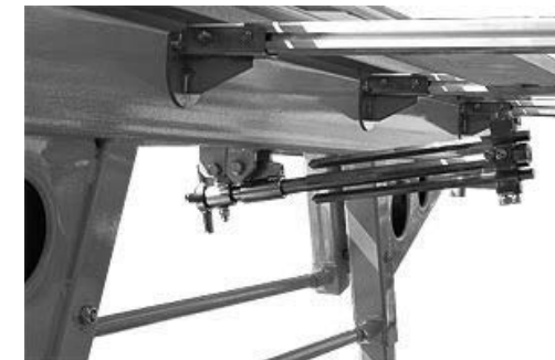
Рис. 3. Система ограничивающая уголгибки станка Metal Master LBM 250
