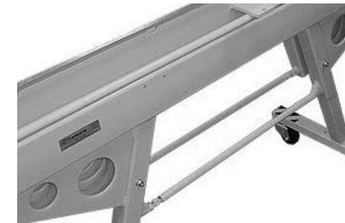
Рис. 4. Рама станка Metal Master LBM 250 со специальными усиливающими тягами
