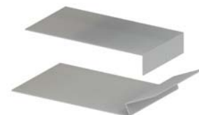
Шаг 4. Делаем следующий гиб (за две установки). Первая установка — гиб на 155 градусов.
