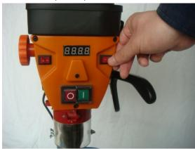
Нанесите на шаблон разметку. Передвигая шаблон по столу станка, совместите точку касания сверла и перекрестие разметки. Выключите станок.
