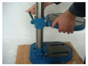
**Шаг 3.** Аккуратно наденьте сверлильную головку на колонну и надежно закрепите двумя винтами, расположенными сбоку.
