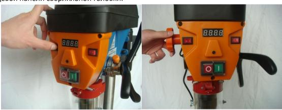
НИКОГДА не регулируйте скорость вращения, когда станок выключен или останавливается. Разрешено регулировать скорость вращения, только когда станок работает.
