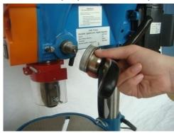
**Шаг 5.**Наверните против часовой стрелки (левая резьба) рукоятку на вал.
