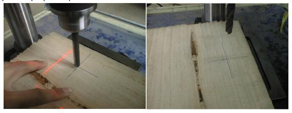
Отрегулируйте лазерный указатель так, что бы перекрестие лазерного указателя и разметка на шаблоне совпали.
