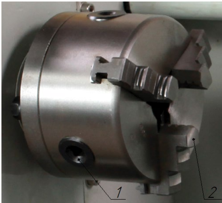
Рис.1 Трёхкулачковый патрон смонтированный в шпинделе настольного токарно-винторезного станка Metal Master MML 210x400V
