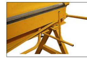
Для работы с листами большого размера станок имеет стол задней поддержки с ручными ограничителями глубины подачи листа. Если необходимо отрезать несколько заготовок одного размера, ограничители устанавливаются спереди станка и служат упорами, задающими размер отрезаемой заготовки
