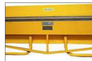
Гибочная балка снабжена усиливающими тягами с возможностью регулировки ее прогиба. Усиливающие элементы позволили сохранить небольшую толщину гибочной балки, что позволяет делать более разнообразные элементы и профили с размерами сечения от 5 до 25 см
