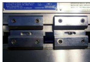
Система крепления верхнего и нижнего инструмента AMADA-PROMECAM
