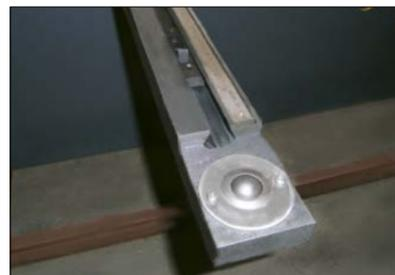
Суппорты с шаровыми опорами, перекидными упорами и миллиметровой шкалой
