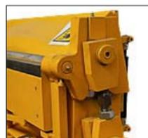
Эксцентриковый механизм подъема прижимной балки обеспечивает высокую производительность оператора
