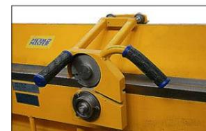
Роликовый нож обеспечивает промышленное качество реза заготовки из стали толщиной до 0,9 мм. Нож имеет ряд регулировок
