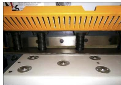
Шаровые опоры стола, откидной защитный барьер для резки коротких заготовок
