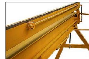
Массивная прижимная балка усилена тягой, препятствующей прогибу балки во время работы листогиба, что обеспечивает стабильное высокое качество изделий
