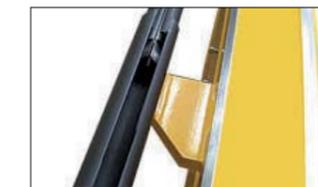
Для изготовления желобов малого радиуса и отливов с плавным завершением используется валок для радиусной гибки листа
