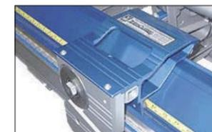
Роликовый нож обеспечивает промышленное качество реза стали до 0,9 мм
