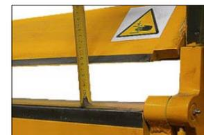
Широкое раскрытие прижимной балки до 80 мм обеспечивает удобное размещение и перемещение заготовки с высокими бортами
