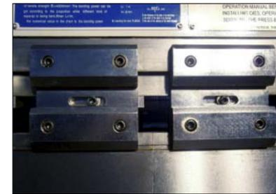
Система крепления верхнего и нижнего инструмента AMADA-PROMECAM
