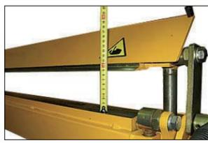
Рекордная среди других аналогов высота раскрытия прижимной балки до 90 мм облегчает размещение заготовки с высокими бортами
