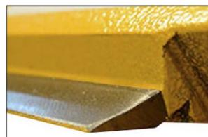
Основное конструктивное отличие LBA-07 от LBA – острая кромка прижимной балки, которая позволяет загибать лист на угол до 155°
