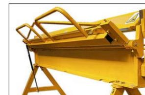
Мощная основная балка не требует установки дополнительных регулировок и усиливающих тяг
