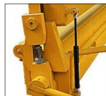
Цельнофрезерованная кромка прижимной балки позволяет работать с большей толщиной металла
