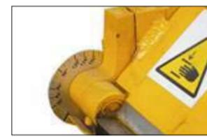
Гибочная балка снабжена угломером, позволяет производить изделия с точно заданным углом гiba
