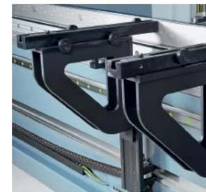
Скользкие передние опоры легко регулируются по вертикали и в поперечном направлении с помощью линейной направляющей и системы шарикоподшипников
