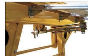
Жидкостный угломер и ограничитель угла поворота гибочной балки позволяют предварительно установить до четырех вариантов угла поворота
