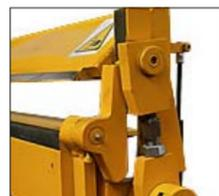
Наличие пневмокомпенсаторов на гибочной и основной балке облегчает работу оператора
